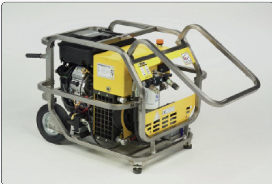
**SUPER RAPTOR** è una centralina idraulica mono utensile con motore a benzina bicilindrico da 18 Hp, disponibile con portate da 20 fino a 38 L/min e pressioni fino a 210 Bar, (secondo la grandezza della pompa installata, esempio 30 litri a 175 Bar oppure 38 litri a 140 Bar). L'accelerazione del motore può essere manuale o automatica con pistoncino.
