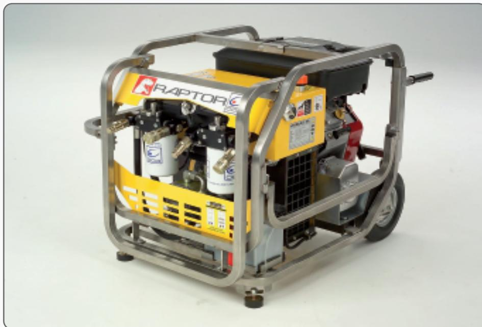
Centralina idraulica biutensile con motore a benzina da 18 Hp, avviamento elettrico e strappo. La **SUPER RAPTOR DUAL** ha una doppia possibilità di fornitura idraulica: o due circuiti idraulici da 19 L/min cadauno oppure uno da 38 L/min con pressione massima di 140 bar. Questa caratteristica permette di usare contemporaneamente due utensili idraulici del gruppo **C** oppure uno solo del gruppo **E** dello standard EHTMA.
