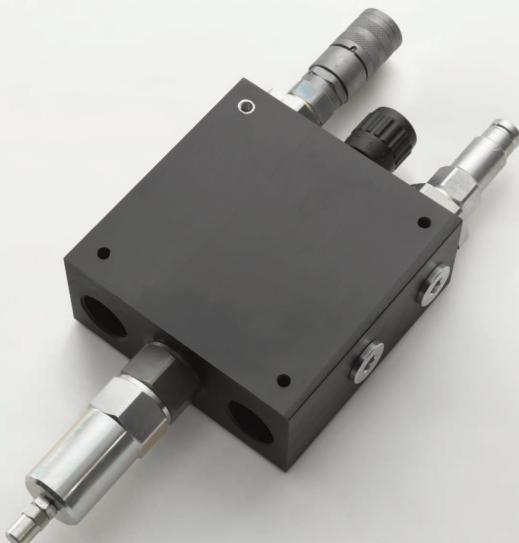
Valvola idraulica per la regolazione dei valori di pressione e portata, assicura che agli utensili vengano forniti i corretti valori idraulici per garantire sicurezza ed evitare danni all'attrezzatura, la valvola ha il corpo in alluminio lamato con superficie anodizzata, gli elementi logici in cartuccia sono della migliore qualità per assicurare una regolazione precisa e stabile.
