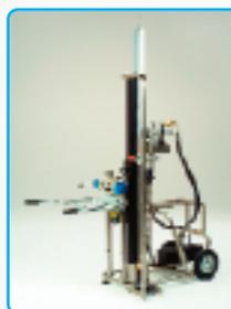
**VEKTOR** è un carrello idraulico progettato come ausilio nelle operazioni di localizzazione di fughe gas da reti interrate, il carrello è azionato da centraline idrauliche ed effettua in modo autonomo ed in sicurezza la foratura verticale di superfici stradali **evitando la possibilità, sempre presente, di forare entrando in contatto manuale con cavi elettrici ad alta tensione, situazione che potrebbe causare infortuni gravi e la morte.**
