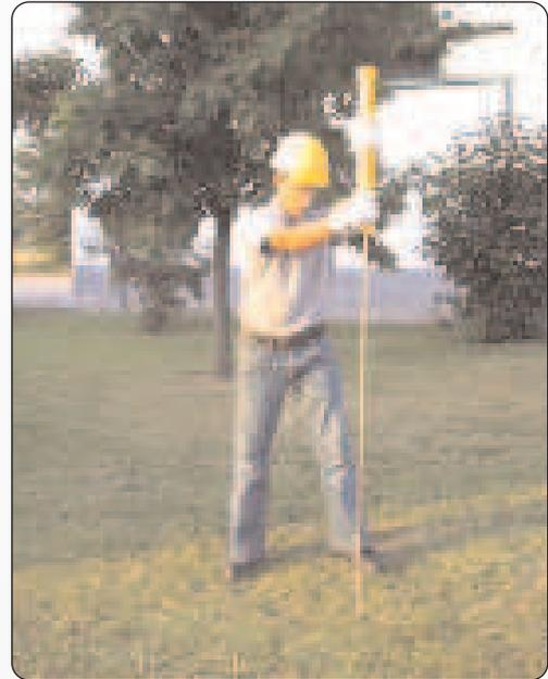
**RP140** è una sonda a percussione manuale progettata per effettuare fori con profondità fino a cm 140 e diametro 14 mm in terreni soffici o moderatamente sassosi.
